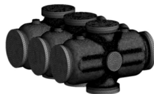
图3 DDS壳体网格划分
